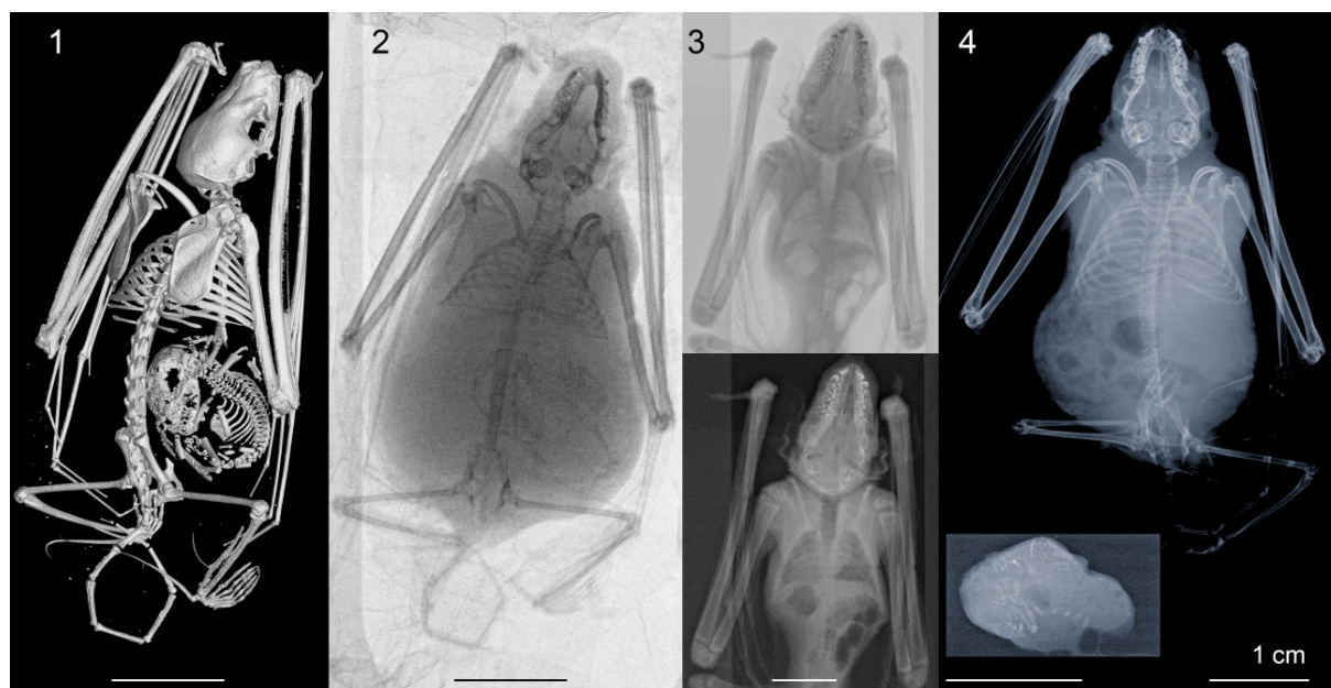
Abb. 1: Anwendungsbeispiele für die in Tab. 1 genannten Röntgenverfahren. – [1] Tomografie einer trächtigen Zwergfledermaus (Auflösung 29,5 \mu\text{m} ) – zur besseren Darstellung des Fötus leicht rotiert (SMF 98605; Mammalogie Senckenberg Frankfurt). [2] Das gleiche Tier als Röntgenpositiv (Auflösung 34,0 \mu\text{m} ) – Aufnahme in der Originalverpackung (verknitterte Alufolie) mit Fixierung in einer Plastikhaltung (am linken Rand sichtbar) für die Aufnahme. [3] Abgemagertes Jungtier einer Breitflügelfledermaus ( Eptesicus serotinus ; Auflösung wie 2) – klar erkennbar bereits im unbearbeiteten Röntgenpositiv (oben) sowie im nachbearbeiteten Röntgennegativ (unten) die offenen Wachstumsfugen der Langknochen (SMF 98606; Mammalogie Senckenberg Frankfurt). [4] Zwergfledermaus-Weibchen mit zwei makroskopisch unstrukturierten blutigen Klümpchen als vermuteter Fehlgeburt von Zwillingen (Auflösung 7 \mu\text{m} ). Das Inset zeigt den Fötus mit bereits deutlich kalzifiziertem Brustkorb; nicht abgebildet ist die etwa gleichgroße Nachgeburt (SMF 98607; Mammalogie Senckenberg Frankfurt). – Maßstab jeweils 1 cm (© Rabenstein, Stiefel).
