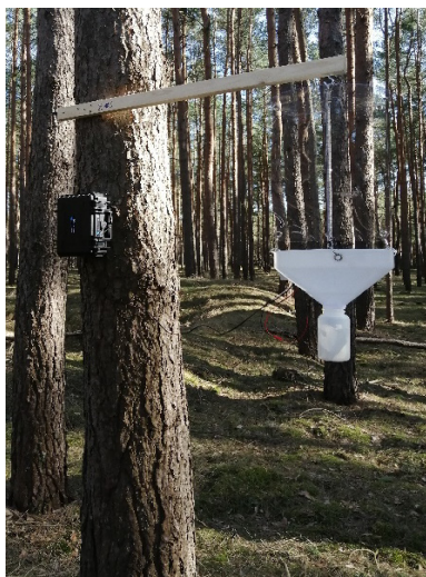
Abb. 2: Fallendesign. Kreuzfensterfalle mit LEDs (Foto: C. Balthasar)
