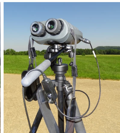
Abb. 24: Sichtbeobachtungen im Bereich des Testfelds (a) mittels Laser-Range-Finder (LRF, b). Im Holzkasten befindet sich der Laptop zur digitalen Speicherung der Daten.
