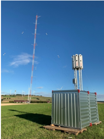
Abb. 59: Detektionssystem Bioseco im Testfeld mit dem östlichen Windmessmast im Hintergrund (a) sowie Luftbild mit den Standorten des Detektionssystems (roter Stern), der beiden Windmessmasten (weisse Fünfecke), der LRF-Sichtbeobachtungen (rosa Punkte) und ein Umkreis von 500 m (gelber Kreis) (Quelle Luftbild: Google Satellite).
