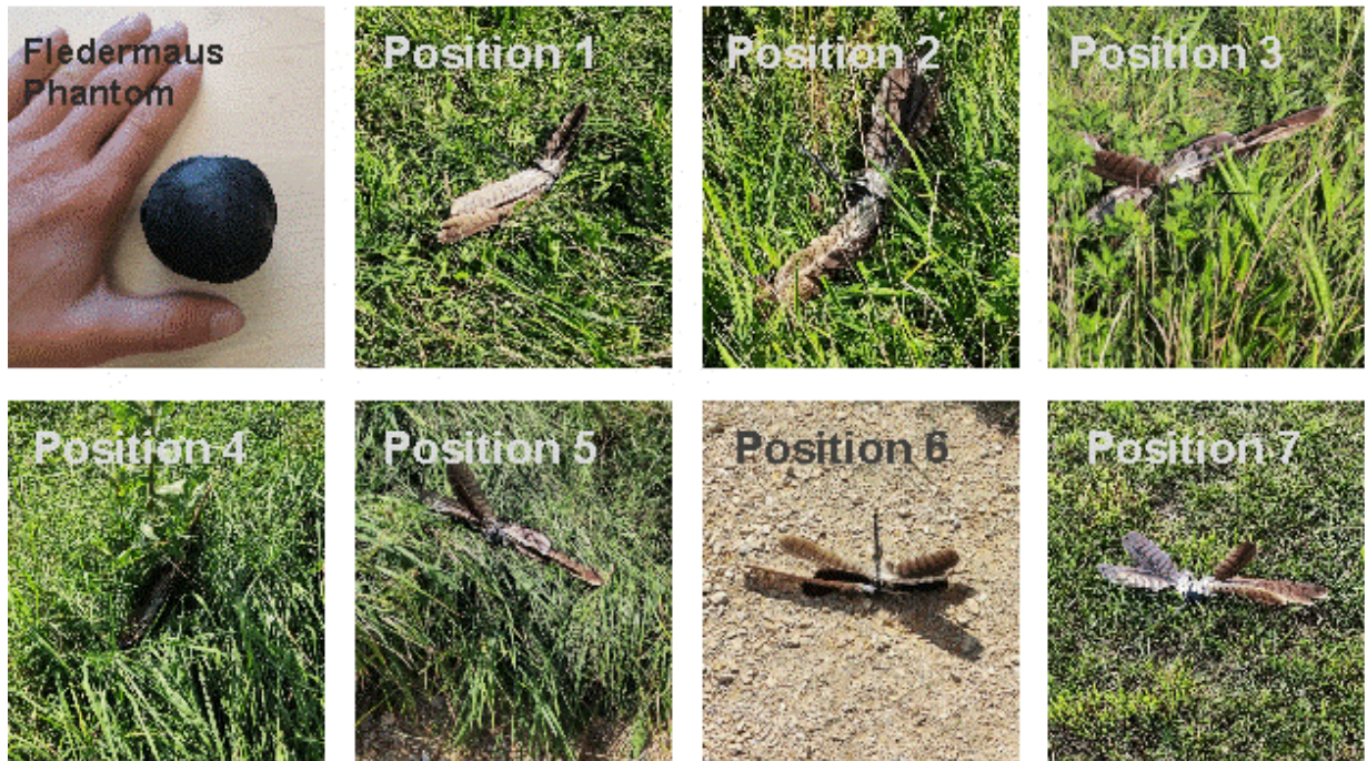
Abb. 190: Phantome für die Detektion bei Tage und nachts mit den dazugehörigen Positionen aus Abb. 191.
