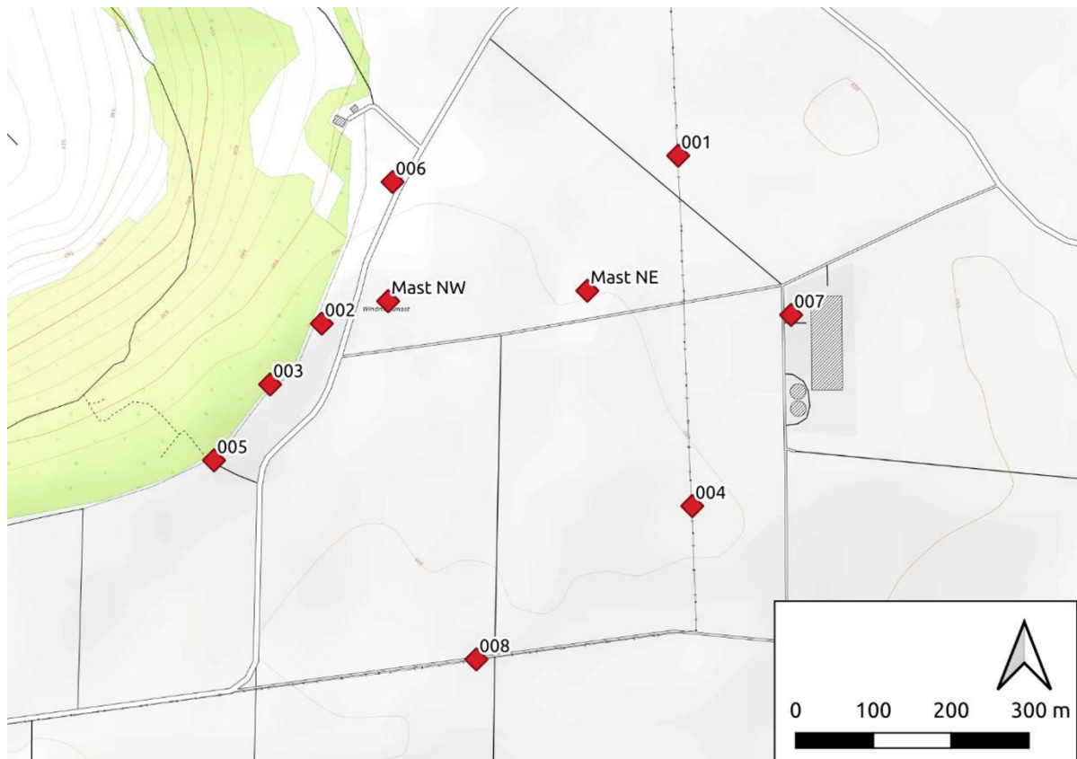
Abb. 200: Übersicht über die Standorte der Insektenfotofallen. Die Insektenfotofallen SN 001, SN 004 und SN 008 (Offenland) wurden an den vorhandenen Strommasten installiert, die Insektenfotofallen SN 006, SN 002, SN 003, SN 005 (an der Waldkante) sowie SN 007 (Offenland) an einer speziell angefertigten Dreibeinkonstruktion angebracht. Die Insektenfotofallen SN 009 bis SN 012 wurden an Messmast NW, die Insektenfotofallen SN 013 bis SN 016 an Messmast NE installiert (Quelle Hintergrundkarte: OpenStreetMap).
