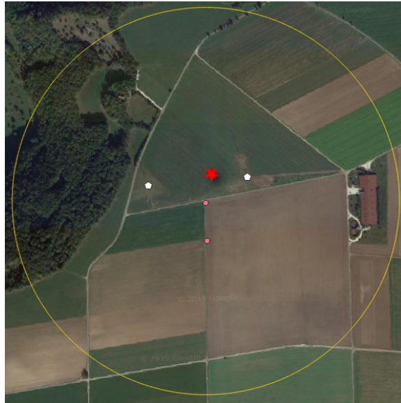
Abb. 59: Detektionssystem Bioseco im Testfeld mit dem östlichen Windmessmast im Hintergrund (a) sowie Luftbild mit den Standorten des Detektionssystems (roter Stern), der beiden Windmessmasten (weisse Fünfecke), der LRF-Sichtbeobachtungen (rosa Punkte) und ein Umkreis von 500 m (gelber Kreis) (Quelle Luftbild: Google Satellite).
