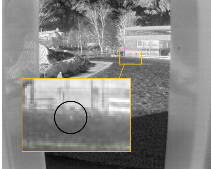
Abb. 181: Testaufnahme bei Tageslicht. Das Testobjekt hat etwa 42°C, befindet sich im Abstand von etwa 80 Metern und hat etwa die Größe einer Handfläche.
