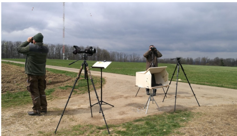
Abb. 24: Sichtbeobachtungen im Bereich des Testfelds (a) mittels Laser-Range-Finder (LRF, b). Im Holzkasten befindet sich der Laptop zur digitalen Speicherung der Daten.
