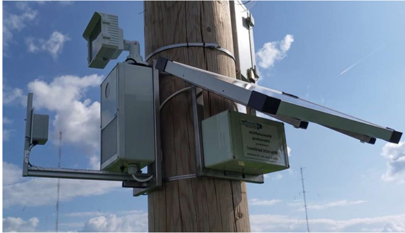
Abb. 195: Installierte Insektenfotofalle im Umfeld der Messmasten. Hier ist die zusätzliche Stromversorgungsbox mit dem Solarpanel gut erkennbar.
