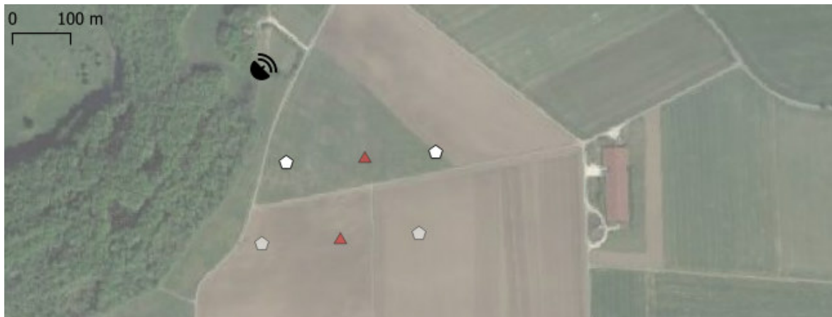
Abb. 4: Standort des Radargerätes (Radarsymbol) nahe dem Testfeld mit den Standorten der bestehenden (weiße Fünfecke) und geplanten (transparente, weiße Fünfecke) meteorologischen Messmasten und den geplanten WEA (transparente rote Dreiecke) (Quelle Luftbild: Google Satellite).
