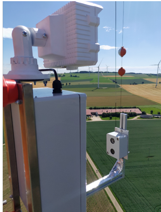
Abb. 201: Installierte Insektenfotofallen am Dreibein – unterhalb des Fledermausdetektors – (linkes Bild) und am Messmasten (rechtes Bild).
