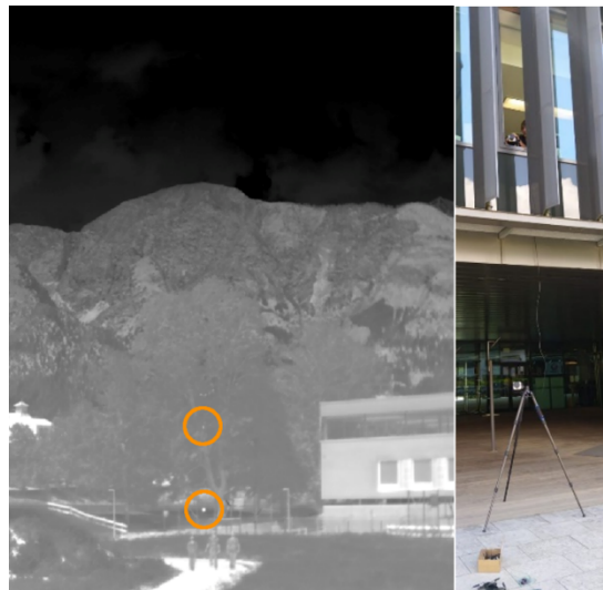
Abb. 157: Wärmepads zur Kalibrierung der Wärmebildkameras Wärmepads sichtbar in Testaufnahmen zur Kalibrierung am Testgeländer der UMIT in Hall in Tirol (links). Die wurden für Testkalibrierungen im Abstand von mehreren Metern aufgestellt (rechts).
