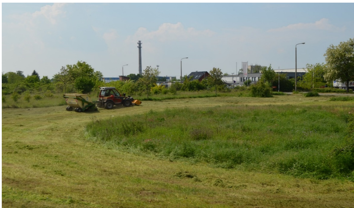
Abb. 27: Mäher mit Kreiselmähwerk und integriertem Fangkorb zur Aufnahme des Mahdgutes (Foto: M.-H. Horschik)
