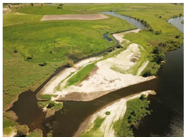
☞ Im Bereich der Salzhavelwiesen wurde ein Altarm wieder an die Havel angebunden.
