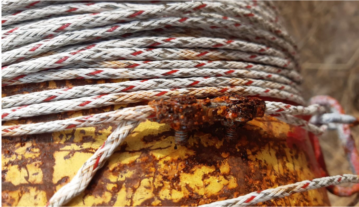
Abb. 15: Rost an Litzenverbindungsschrauben (Bild: Timo Nolte).
