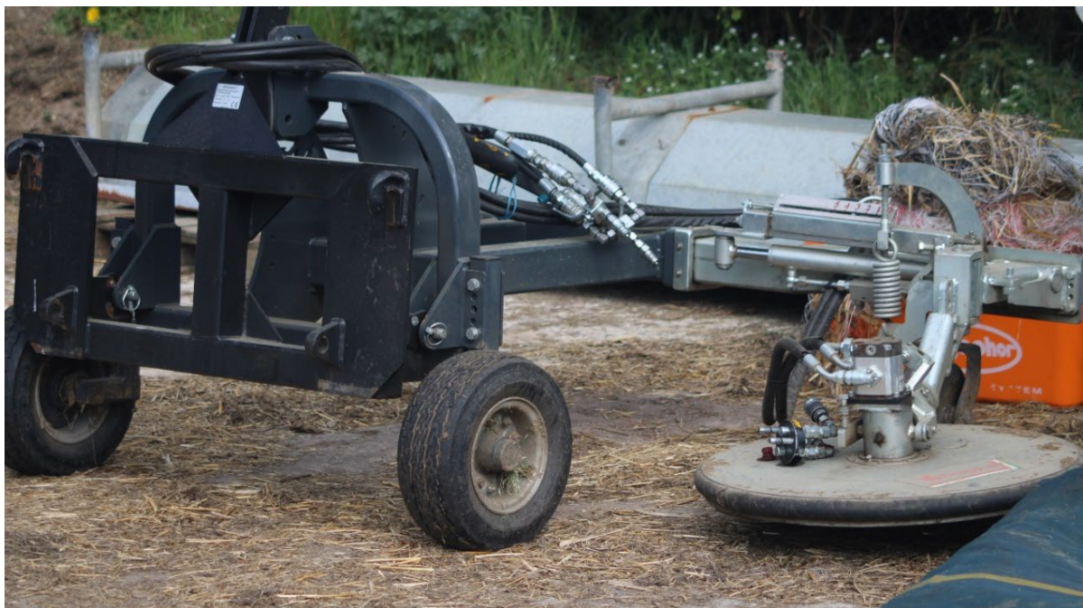
Abb. 12: Hydraulisches Mähsystem mit Mähteller, einsetzbar unter dem untersten elektrischen Leiter in 20 cm über Boden (Bild: Peter Schütte).
