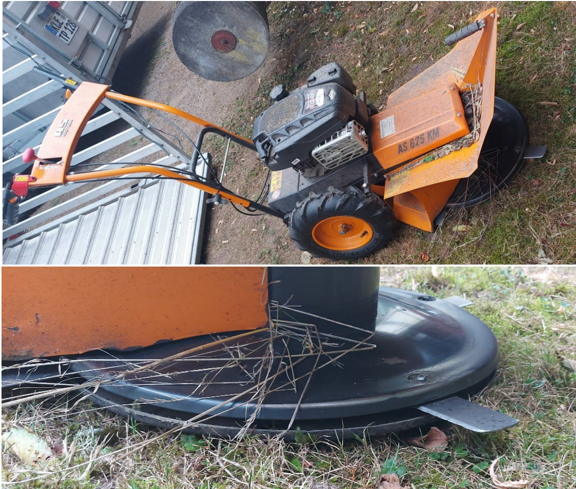
Abb. 65: Kreiselmäher und Mähteller, welcher zum Freischeiden der Zauntrasse genutzt wird (oberes Bild: Gesamtansicht, unteres Bild: Detail Mähteller; Bilder: Timo Nolte).
