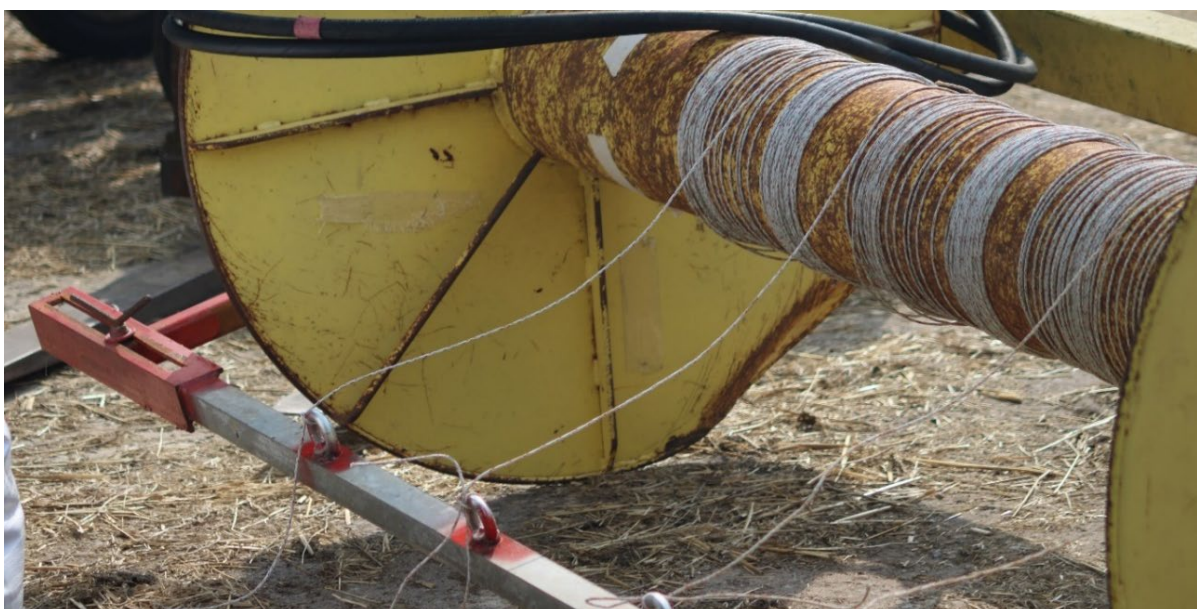
Abb. 14: Walze für die Fronthydraulik zum Aufwickeln der Kunststofflitzen (Bild: Peter Schütte).
