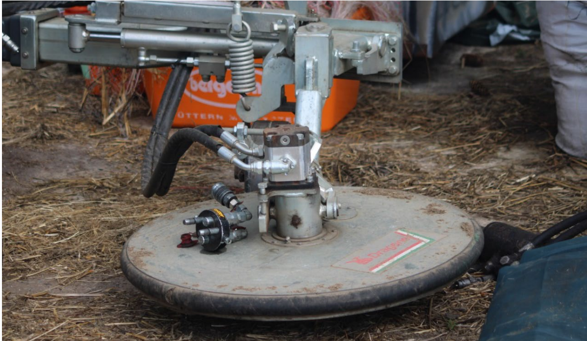
Abb. 13: Mähteller mit Feder und Hydraulik (Bild: Peter Schütte).
