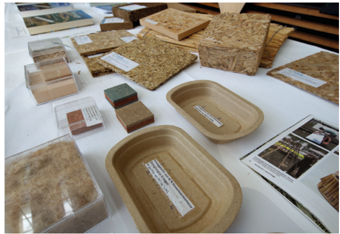
Abb. 3: Verschiedene Produkte aus Moorbioasse, darunter Einweggeschirr, Bau-, Dämm- und Faserplatten aus Rohrkolben ( Typha ), Rohrglanzgras ( Phalaris ) und Seggen ( Carex ). (Foto: Stephan Busse)
