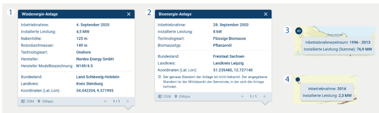
Abb. 34: Web-GIS – Pop-Up-Fenster am Beispiel Windenergie-Anlage (Bildbereich 1) und Bioenergie-Anlage mit Hinweis über unbekanntem genauen Standort (Bildbereich 2). Tooltip-Fenster bei Anlagen-Cluster (Bildbereich 3) und Einzelanlage (Bildbereich 4)
