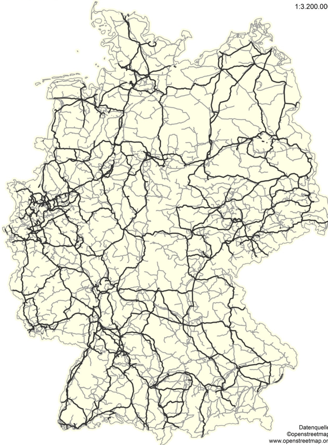
Abbildung 31: Freileitungen der Hoch- und Höchstspannungsebene und deren räumliche Verteilung in 2016.
