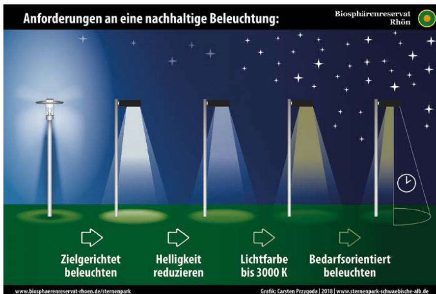
Abb. 1: Schematische Darstellung der Grundsätze einer möglichst umweltschonenden Beleuchtung. (Quelle: UNESCO-Biosphärenreservat Rhön, Graphik: Carsten Przygoda)
