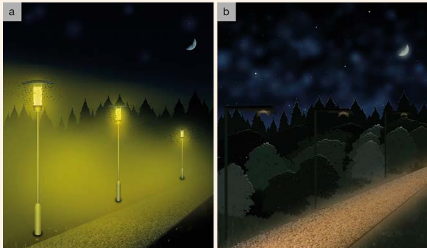
Abb. K1-1: Der Entwurf der Straßenbeleuchtung zielt auf eine Lichtverteilungskurve mit Lichtstärke von 0 Candela (cd) im Nichtzielbereich ab, um Lichtemissionen in der Flughöhe von Insekten möglichst zu vermeiden, um die Anziehung von Insekten und die Zerstörung ihrer Lebensräume zu verringern und um gleichzeitig eine angemessene nächtliche Beleuchtung in Wohngebieten zu gewährleisten: a) Straße mit bisheriger Beleuchtung, b) Straße mit neu entwickelter Beleuchtung. Verändert nach Schroer et al. (2021).
